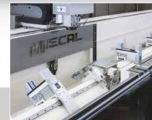
Le morse di bloccaggio del pezzo scorrono su guide di precisione e possono essere posizionate automaticamente tramite montante mobile (variante DPM), o con motorizzazione indipendente su ogni singola morsa (variante MMI)
