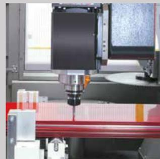
Le morse di bloccaggio del pezzo scrono su guide di precisione e sono posizionate con motorizzazione indipendente su ogni singola morsa, gestita da CNC
